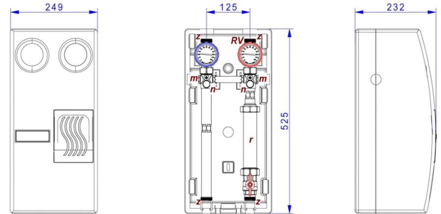
Описание: z – резьба 1" НР; n – заглушка для подключения датчика Ø5-5,2 мм, M10x1; m – муфта для погружной гильзы 1/2" (заглушена); r – распорная трубка 1 1/2" НР, L=180 мм; RV – обратный клапан.
