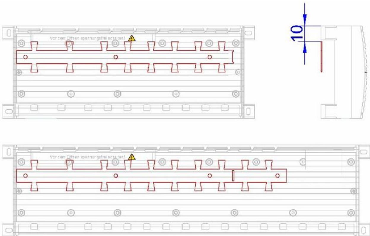
Рис. Положение крепежной планки под корпусом
