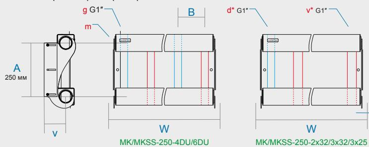
\* Подключения **d** и **v** можно использовать как дополнительный контур-потребитель.
