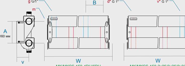
Рис.4. Габаритные размеры серии MK/MKSS-250
