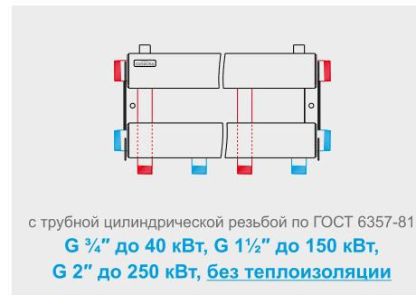
с трубной цилиндрической резьбой по ГОСТ 6357-81
