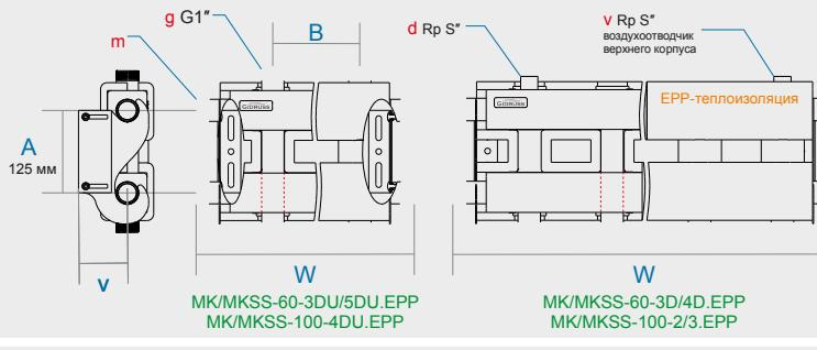
Рис.3. Габаритные размеры серии MK/MKSS-150
