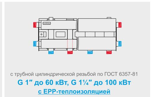
с трубной цилиндрической резьбой по ГОСТ 6357-81
