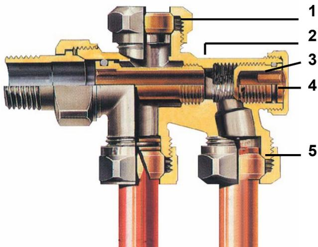
1. Фитинг подключения медной трубы, идущей к термостатическому клапану.
