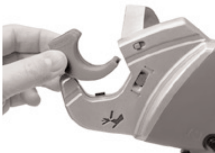
Рис. 7 – Установка переходника лотковой опоры для многослойных труб
