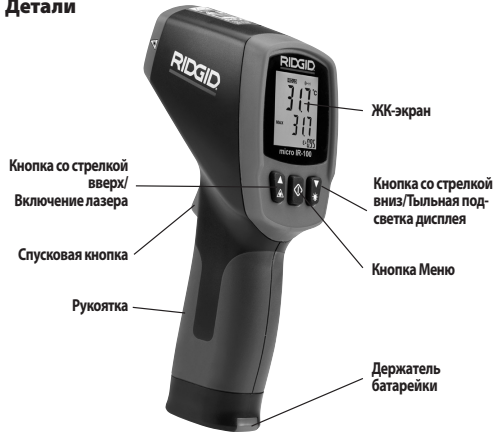
Рис. 2 – Детали прибора micro IR-100
