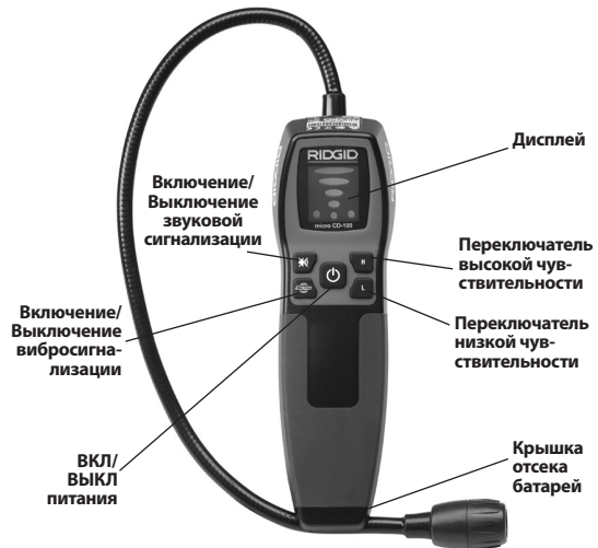
Рис. 2 – Детали прибора micro CD-100
