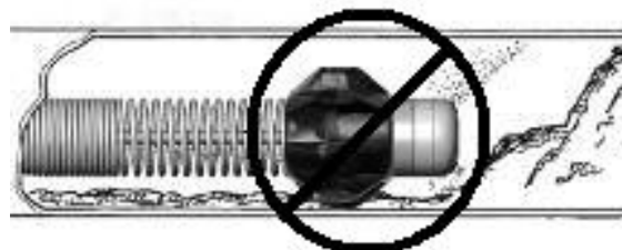
Рис. 17. Препятствие – Не используйте головку камеры для устранения препятствий
