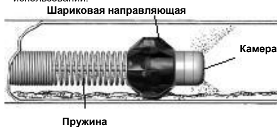
Рис. 12. Шариковая направляющая в использовании
