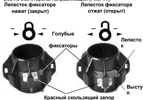
ЗАБЛОКИРОВАН/ РАЗБЛОКИРОВАН/ ЗАФИКСИРОВАН РАСФИКСИРОВАН Рис. 11. Установка шариковой направляющей
