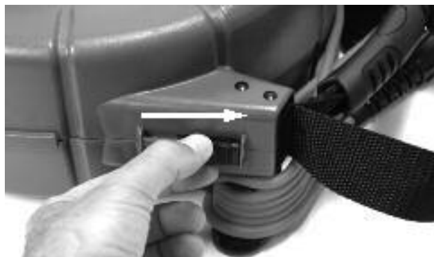
Рис. 4. Отстегивание корпуса барабана microDrain
