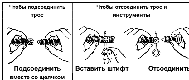
Рис. 1: Соединение и разъединение тросов и инструментов
