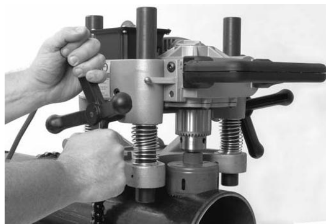
Рис. 11 - Работа на станке для вырезания отверстий
