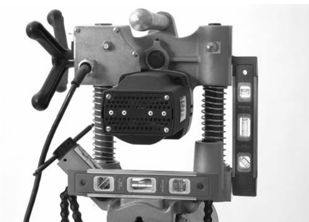
Рис. 10 – Выравнивание станка HC-300
