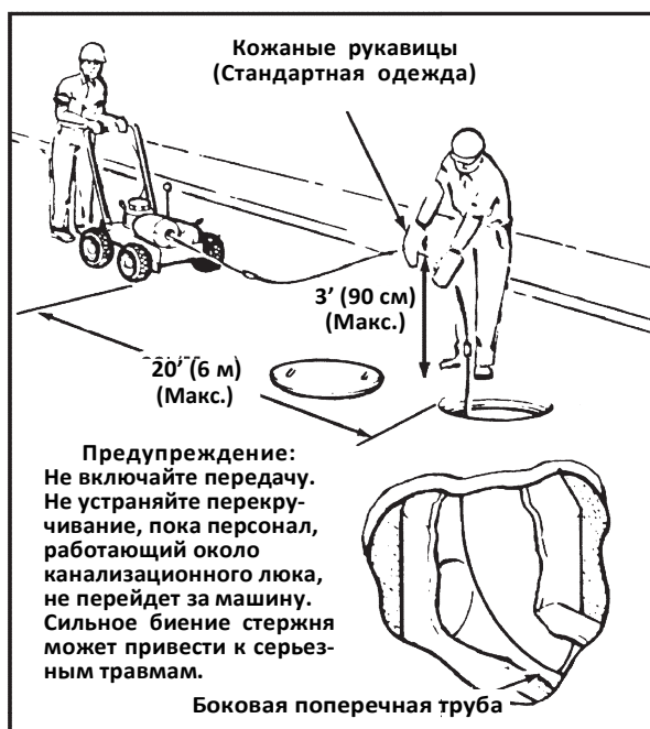
Рис. 3 – Использование стержневой прочистной машины
