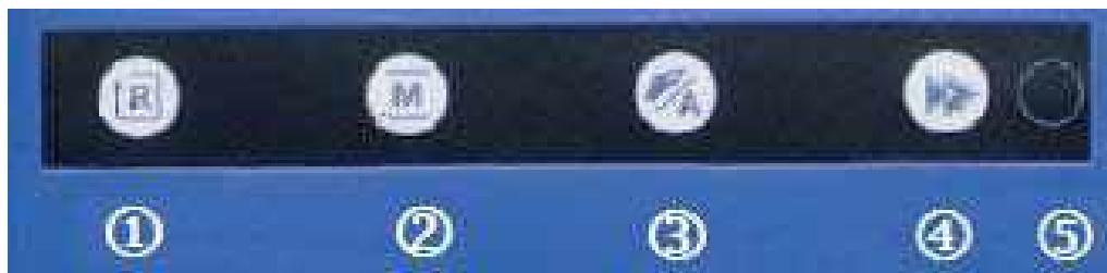
**Кнопка 1: Регенерация.** Используется для: ручного запуска регенерации; запуска тестовой регенерации (совместно с кнопкой 3); прерывания регенерации (совместно с кнопкой 2)
