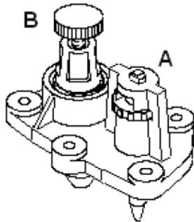
**!** **ВНИМАНИЕ:** При высоком показателе параметра железа на установке BWT Rondomat mix A27 не рекомендуется подмес байпасной нефильтрованной воды. Полностью закрытый регулятор настройки предотвратит выход воды с превышенным показателем железа.
