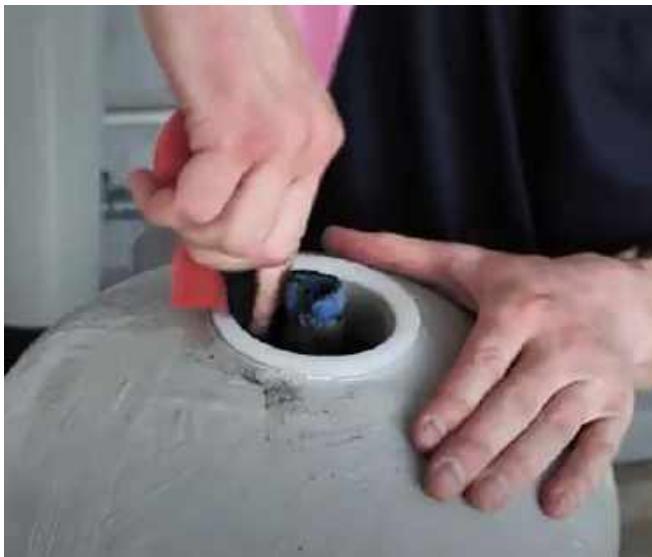
Аккуратно посадить управляющий клапан с верхним дренажным устройством на водоподъемную трубу, слегка нажав на клапан сверху до исчезновения зазора между горловиной корпуса и резьбой корпуса клапана.
