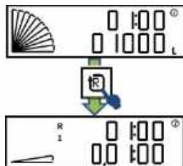
Для запуска тестовой регенерации нужно нажать одновременно кнопки 1 и 3 и удерживать 5 сек. Начавшаяся регенерация будет проводиться в соответствии с программой. Однако при этом на каждой стадии возможен ускоренный переход к следующей нажатием кнопки 2. Регенерация, запущенная в тестовом режиме, не учитывается в статистике регенераций.
