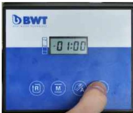
**-Период промывки:** снова нажмите клавишу функции «Function 2». Когда вы отожмете клавишу, загорится индикатор периода промывки в минутах «period in min». Период промывки (т.е., общий период) можно установить от 10 до 34 минут, с шагом последующих увеличений в 2 минуты. Пользуйтесь при этом клавишами подачи «Advance 4» и полуавтоматического режима «Semi-auto».
