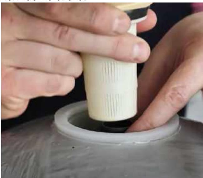
Вращая по часовой стрелке, плотно закрутить блок управления в корпус фильтра.
