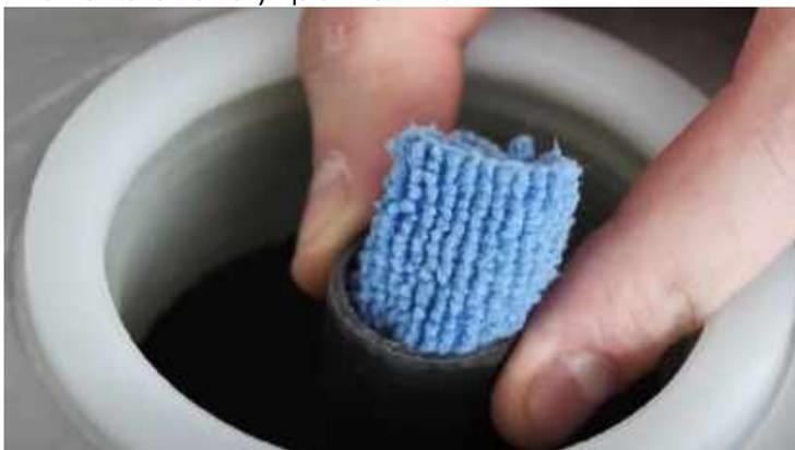
Заполнить корпус фильтра водой приблизительно на 1/4 объема. Вода служит буфером при засыпке фильтрующего материала.
