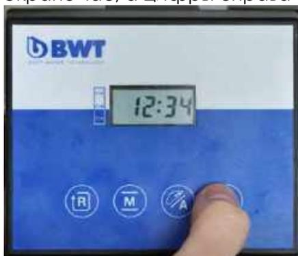
**-Установите частоту промывки:** нажмите клавишу функции «Function 2» на 5 секунд. Когда вы отождмете клавишу, в левой части экрана появится индикатор частоты промывки в днях (frequency in days, «P11»). На экране отобразится интервал между операциями промывки в днях. Для изменения частоты промывки нажимайте клавиши «Advance 4» и «Semi-auto» так же, как и при установлении времени
