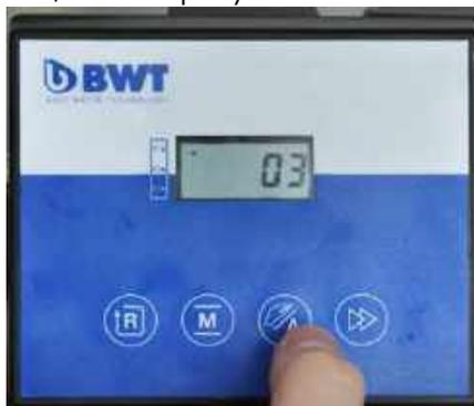
**-Изменение времени промывки:** снова нажмите клавишу функции «Function 2». Когда вы ее отождмете, на экране загорится индикатор времени промывки «washing time». Для изменения времени начала промывки нажмите клавиши подачи «Advance 4» и полуавтоматического режима «Semi-auto» тем же образом, что и при установке времени.
