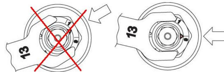
10.12. С помощью комплектного пластикового колпачка допускается перекрытия потока теплоносителя при перепаде давление не более 0,1 бар. При перепаде давления от 0,1 до 10 бар для полного перекрытия потока теплоносителя (например, при замене радиатора) следует использовать латунный колпачок VT.PTV.30.0. Термоголовка полностью клапан не перекрывает (защита от замораживания).
