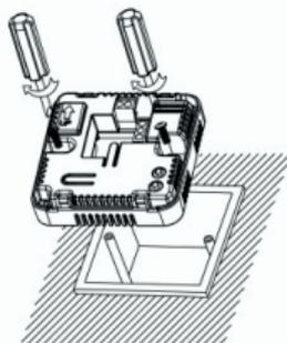
1. С помощью небольшой отвертки слегка ослабьте винт, расположенный у основания корпуса приёмника. Затем вы можете аккуратно отделить переднюю панель от задней панели;
