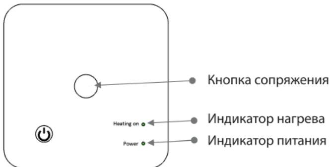
Обычно термостат и приёмник подключаются на заводе-изготовителе, в противном случае вы можете выполнить сопряжение, следуя приведенным ниже шагам:
