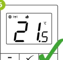
Оба устройства были успешно сопряжены. Термостат покажет на главном экране, значок «(globe)» указывающий на успешное сопряжение
