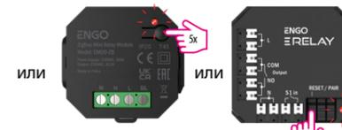
Чтобы правильно связать термостат с реле, сначала быстро нажмите кнопку на реле 5 раз. Светодиод начнет медленно мигать красным цветом, что означает, что устройство находится в режиме привязки.
