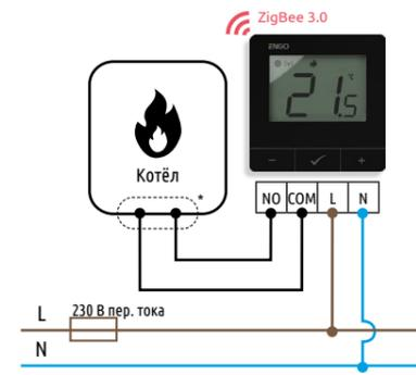
b) Схема подключения к сервоприводу/наосу
