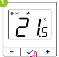
Используйте кнопку - или + для перемещения между параметрами. Введите параметр с помощью ✓. Отредактируйте параметр с помощью - или +. Подтвердите новое значение параметра с помощью кнопки ✓.
