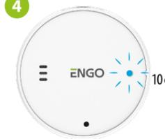
После успешной синхронизации светодиод будет светиться синим цветом в течение 10 секунд.
