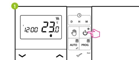
Нажмите кнопку ⏸, чтобы перейти в режим выключения регулятора.
