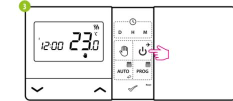
Для выхода из режима выключения нажмите кнопку ⏸ ещё раз. Регулятор вернётся в предыдущий режим работы.
