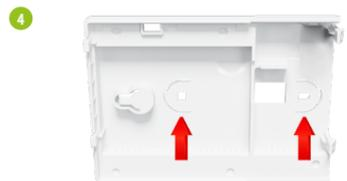
Затем прикрепите заднюю крышку к стене, используя входящие в комплект крепёжные винты и предусмотренные отверстия. (см. красные стрелки).
