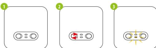
Если вы хотите выполнить повторное сопряжение устройств друг с другом и добавить их в приложение позже, убедитесь, что приёмник отключен от источника питания, а переключатели на нём стоят в положениях AUTO и ON. Затем подключите приёмник к источнику питания и подождите несколько секунд. Быстрым движением переместите верхний переключатель в положение OFF и верните его в положение ON. Нижний оранжевый светодиод начнёт мигать, что подтвердит переход приёмника в режим сопряжения с регулятором.
