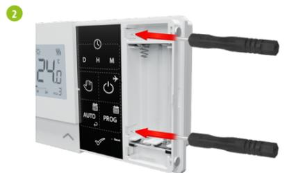
Используйте отвертку, чтобы вдавить пластиковые защёлки до ощущения сопротивления, и наклоните переднюю часть кожуха.
