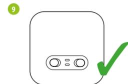
Оранжевый светодиод на приёмнике перестанет мигать. Устройства стали сопряжёнными на новой частоте.
