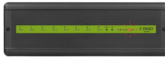
Убедитесь, что блок подключен к источнику питания. Удерживайте нажатой кнопку PAIR в течение 5 секунд. Диод Power должен мигать красным. Планка перейдёт в режим сопряжения.
