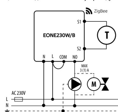
c) Схема подключения к блоку управления
