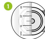
Измерьте диаметр клапана. Выбирайте ETRV исходя из диаметра: для резьбы 30 мм (M30), для 28 мм (M28).
