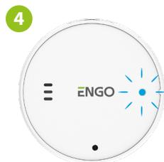
После успешной синхронизации светодиод будет светиться синим цветом в течение 10 секунд.
