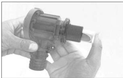
3 Установите рычаг (поз. 7) на посадочные места клапана (поз. 8 и 9).
