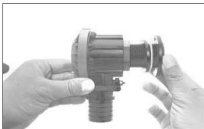
2 Вставьте фильтр (поз. 10) во входной резьбовой патрубок клапана, чтобы защитить внутренние части клапана от засорений и повреждений.
