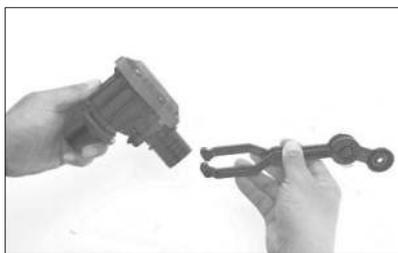
4 После установки рычага проверьте его ход.
