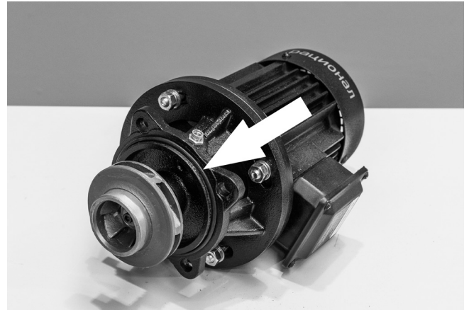
Демонтируйте кольцевое уплотнение (O-ring)
