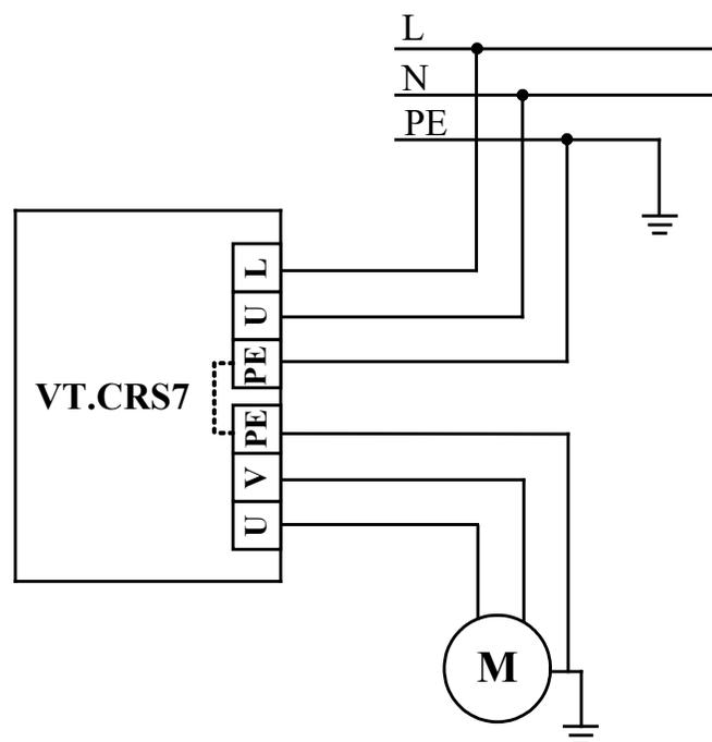
При необходимости подключения насоса с трёхфазным питанием, или однофазного насоса с потребляемым током свыше 10А – насос следует подключать к устройству через магнитный пускатель. Рекомендуется использовать кабель 3x1,5 мм<sup>2</sup> с наружным диаметром 8,6-9,0 мм.
