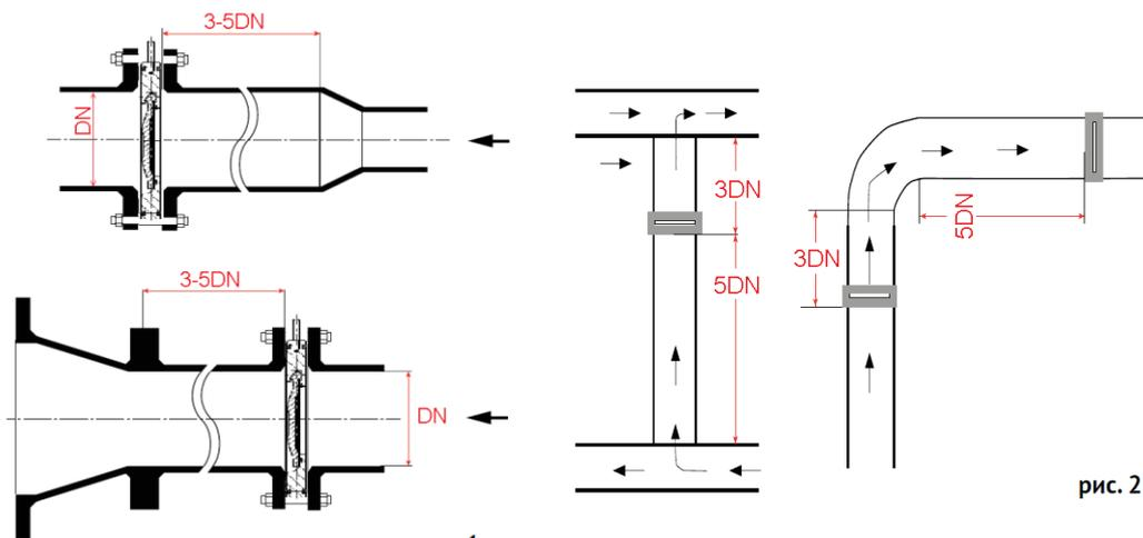
**ВНИМАНИЕ!** Предпочтительное монтажное положение на наклонном или вертикальном трубопроводе при направлении движения воды снизу-вверх.
