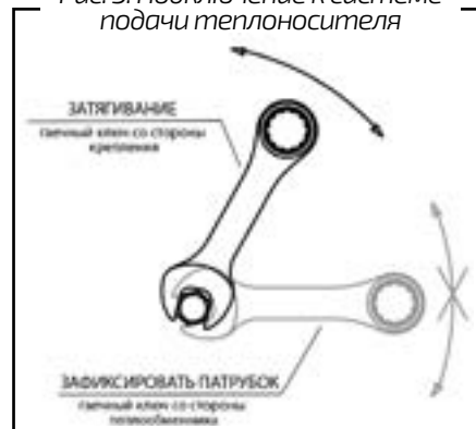
Рис. 3. Подключение к системе подачи теплоносителя
